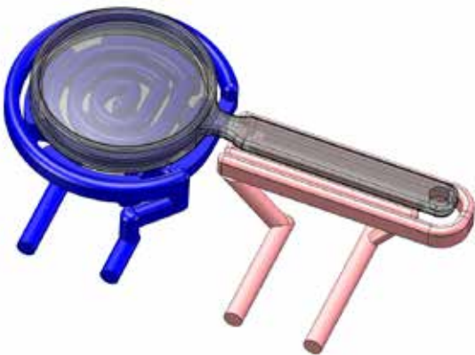
Konturfolgende Temperierung der Auswerferseite. Steuerbar in zwei unterschiedlichen Kreisläufen.
