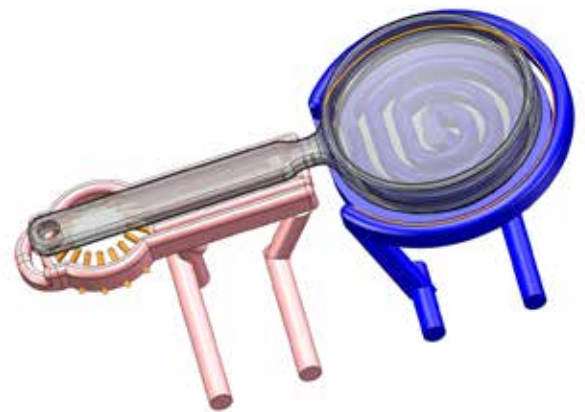
Lage der variothermen, konturnahen Temperierkanäle auf der Düsen- und Auswerferseite, aufgeteilt in zwei Zonen.
